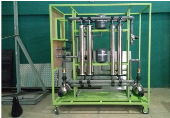
Gambar 8. Unit Ultrafiltrasi Yang Telah Dirakit
